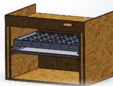
Figura 2. Diseño cubo y hueveras de la incubadora
