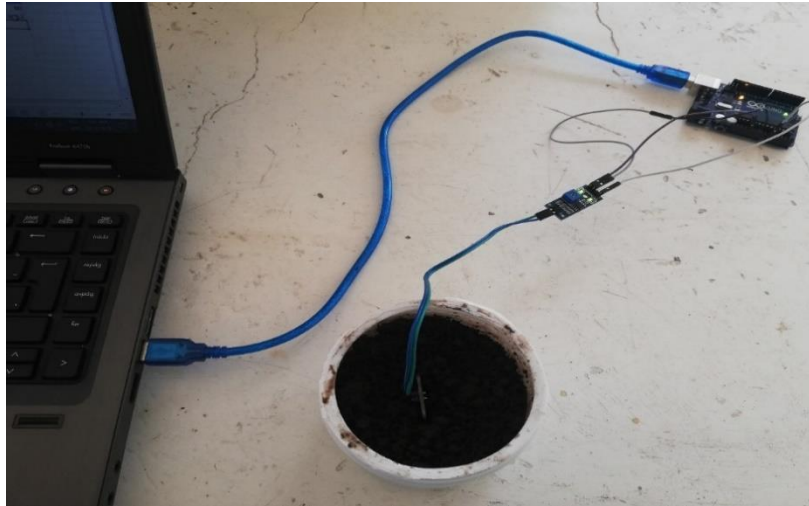
Figura 2. Integración de la electrónica para detección de humedad.
