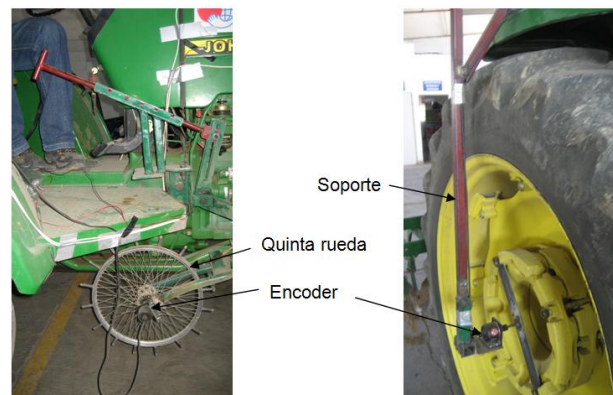
Figura 1. Encoders sujetos al eje del tractor y a la quinta rueda.
