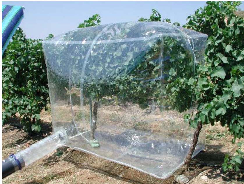
Fig 1.- Sistema abierto para la medición del intercambio de gases a nivel de toda la cepa
