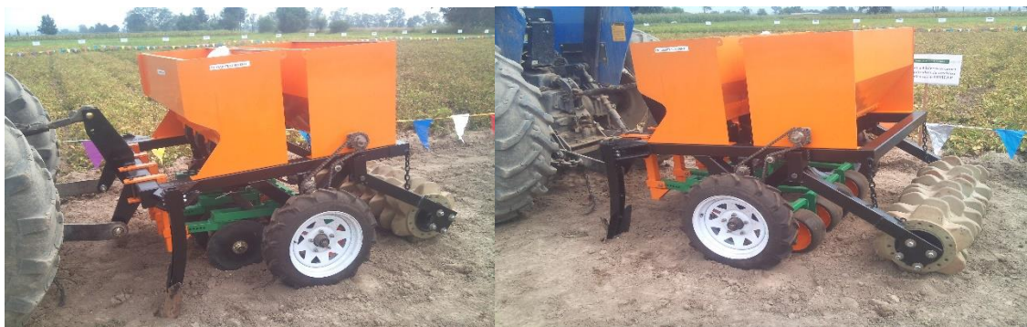
Figura 2 a y b. Construcción física del prototipo de sembradora de precisión mecánica para siembra en cama con tres y cuatro hileras construida en el área de mecanización del CEPAB-AGS.
