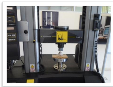
Figura 2. Máquina INSTRON 4469, bajo carga a compresión.
