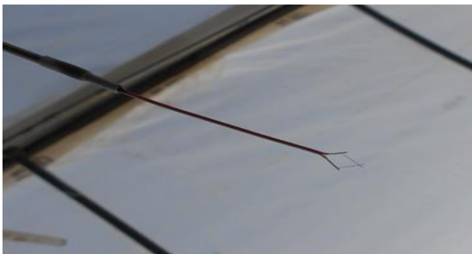
Figura 2. Termopar de alambre fino tipo E utilizado para medir la temperatura del aire del invernadero.
