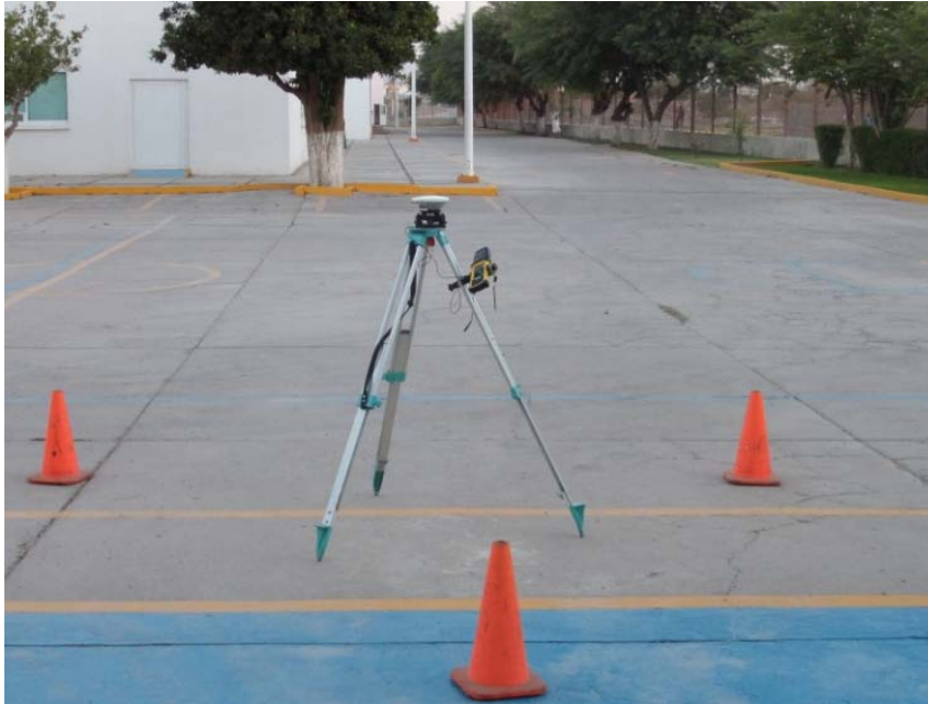
Figura 1. GPS base localizado en un punto de coordenadas geográficas conocidas.
