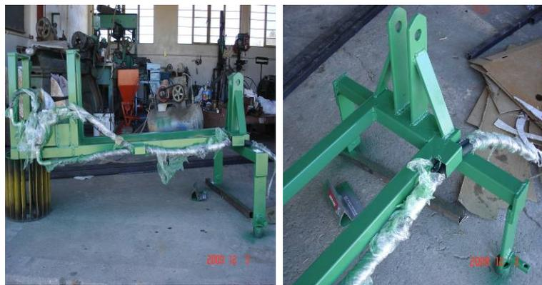
**Figura 2.** Ensamble integral de chasis y sistema de enganche del recogedor.
