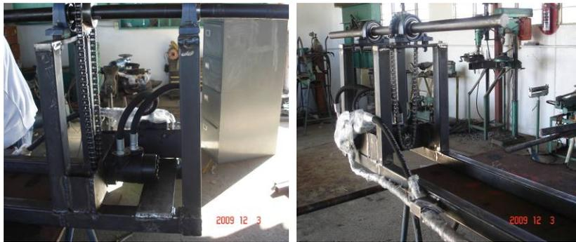
**Figura 1.** Sistema motriz del recogedor (motorreductor y cadena).
